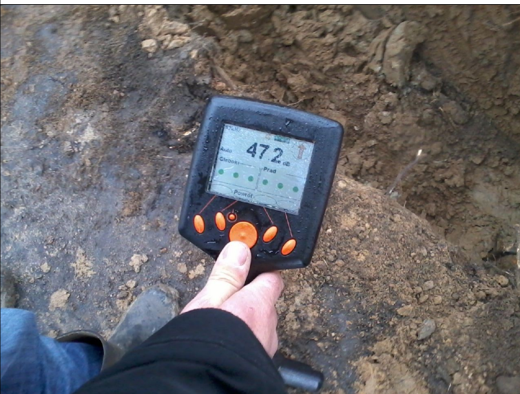
Pracownik gazowni bada głębokość, na której znajduje się sieć Gazociągu Jamalskiego, i kierunek przepływu gazu. (Fot. Krzysztof Kańczkowski)
